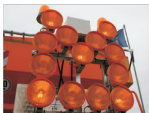
V127 Výstražné osvětlení - LED rampa
